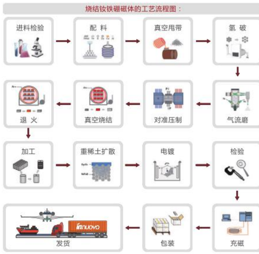
图 3-3 烧结钕铁硼磁体工艺流程图
