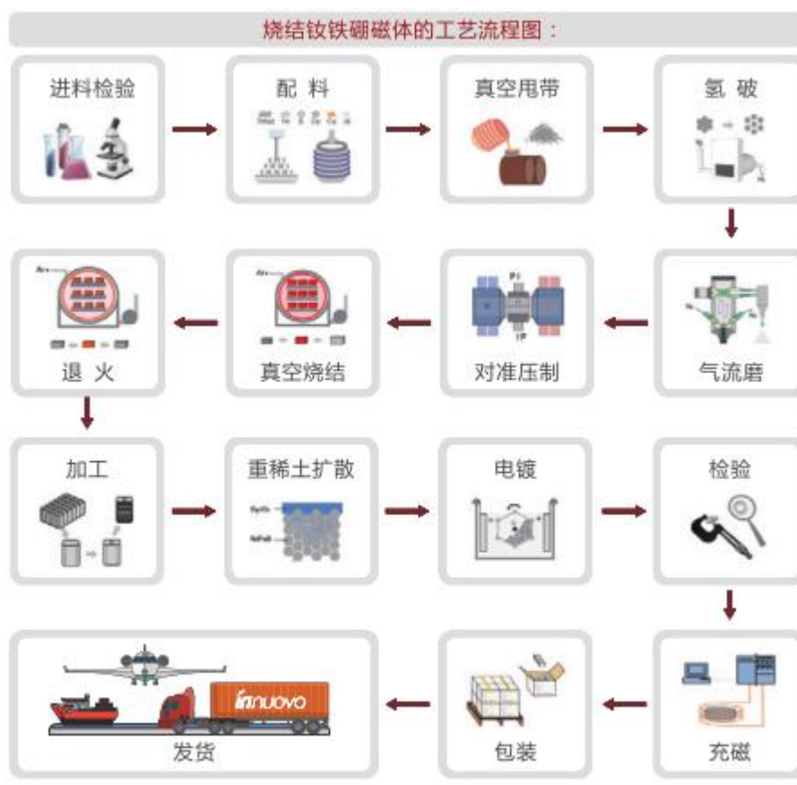
图 3-3 烧结钕铁硼磁体工艺流程图
